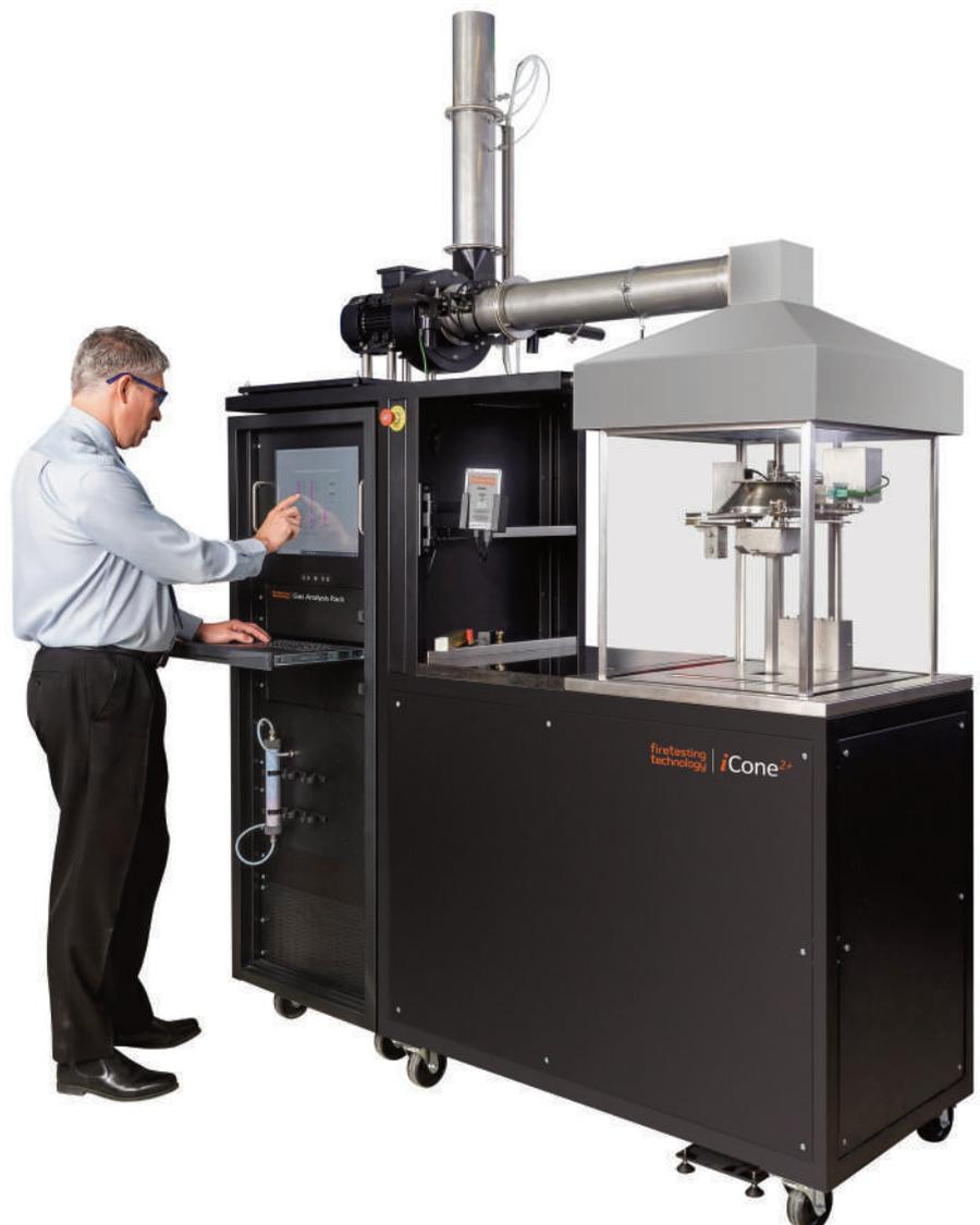
Figure 1: **FTT** ISO 5660-1 *iCone*<sup>2+</sup> Calorimeter
